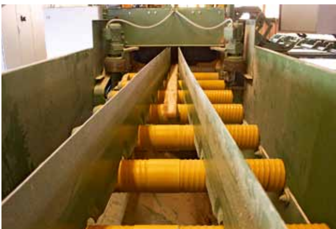
Automatische Separierung: Die Trennvorrichtung verstellt sich von Schnitt zu Schnitt, die Spreißel fallen über die Rollen automatisch nach unten
