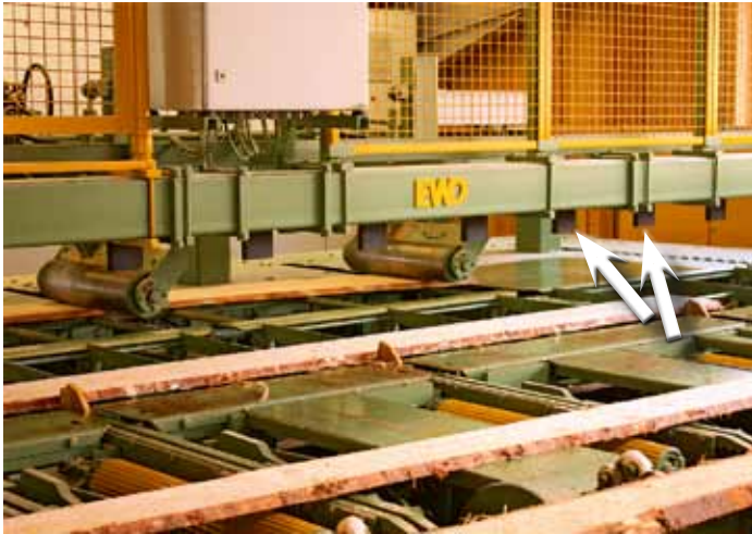
13 Laser im 50 cm-Abstand (Pfeile) ermitteln im Querdurchlauf die Dimension der Schnittware für die Optimierung
