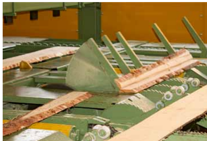
Zwei Nullsägen stehen für Schwartenanläufe zur Verfügung, eine Schwenkvorrichtung entsorgt die Reststücke
