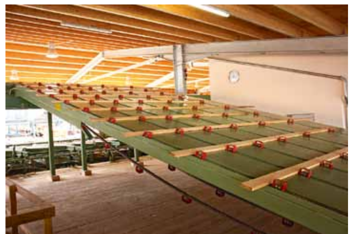
Sauber geschnitten und in geordneten Bahnen verlässt das Schnittholz die Sägelinie in Richtung Sortierung
