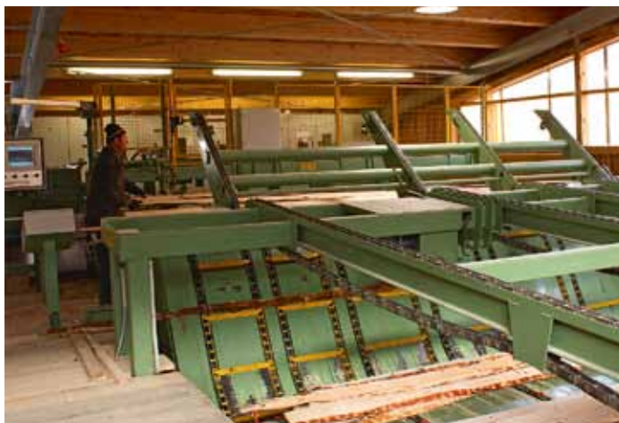
Auf zwei Ebenen kann das Holz – vom Gatter kommend – zum Combimes zugeführt werden
